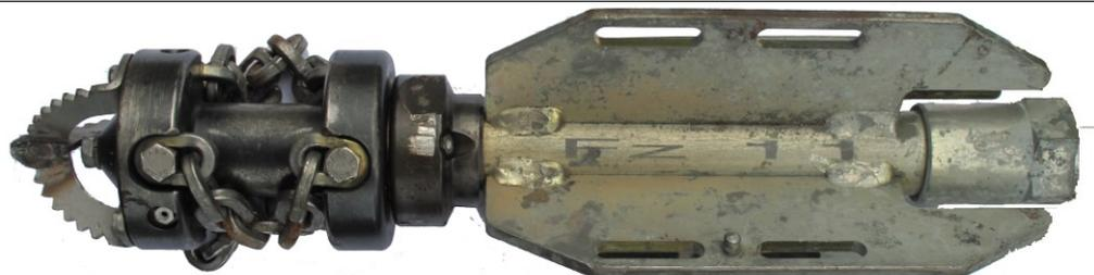
Figur 7: Kettenschleuderdüse
